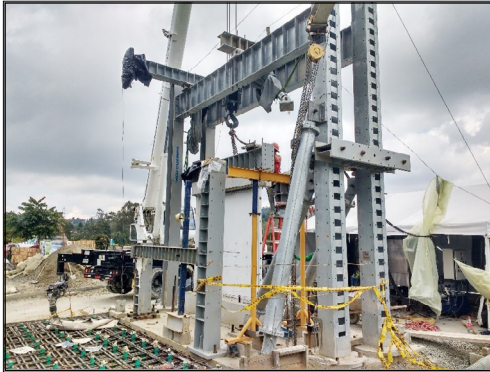
2. PREPARACIÓN DEL MONTAJE PARA ENSAYO DE MURO DELGADO EN EL LABORATORIO DE MECÁNICA ESTRUCTURAL UNIVERSIDAD EIA
